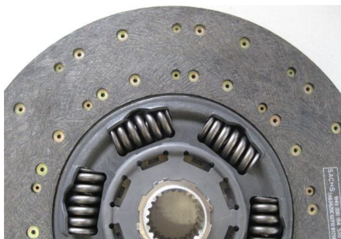
Rys. 2: Okładzina od strony skrzyni biegów
